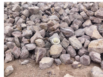
Producto Rip Rap acabado en la pila utilizando un casco como referencia de tamaño
