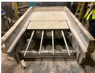
Criba de Rip Rap de la planta primaria de Dells East
